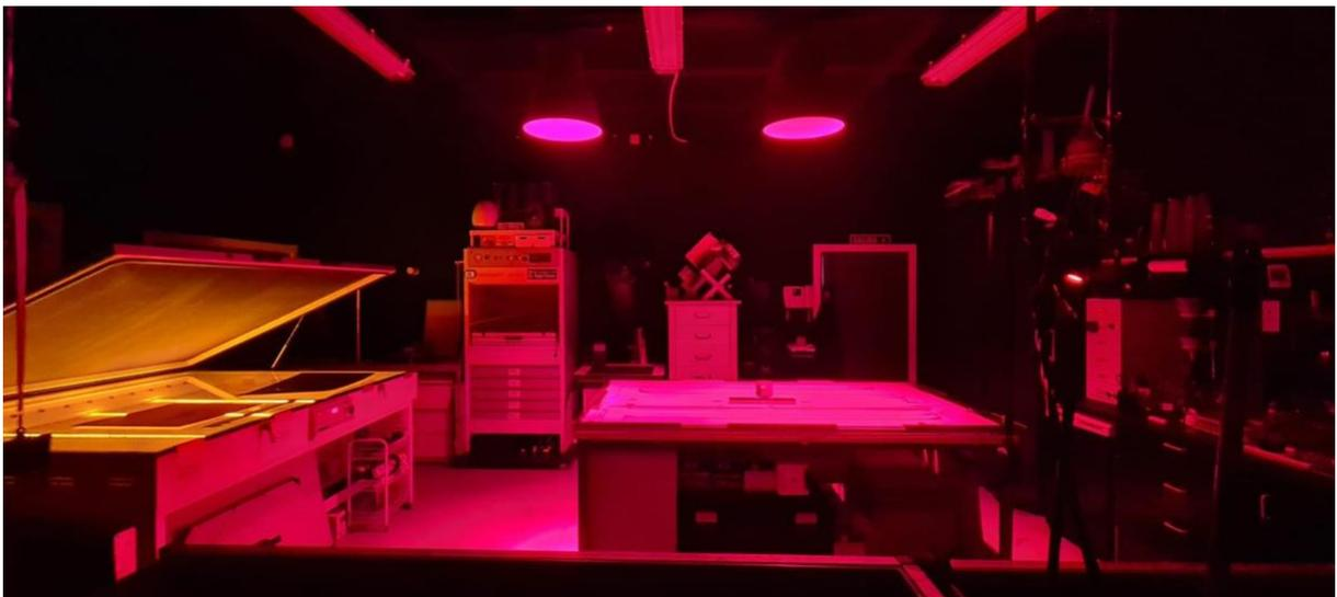
**Panorámica del laboratorio analógico dentro de *La Tercera Nave*. Una sala emocionante con todo tipo de maquinaria. A la izquierda, con luz naranja, una insoladora led. De frente, con cajones, una insoladora de arco.**
